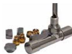
A<sup>2</sup> **Kit monotubo** formado por válvula monotubo de escuadra, juego de adaptadores para tubo de cobre de 15 mm y de multicapa de 16 x 2 mm y sonda. Incluye tapón adicional.
